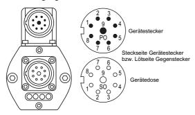
9 pol. Gerätestecker M23, Interbus-Norm 1 x Stiftkontakte, 1 x Buchsenkontakte
