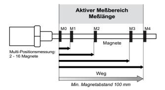
Die Multi-Positionsvariante des INTERBUS-S Sensors ist aus der Standardversion abgeleitet.
