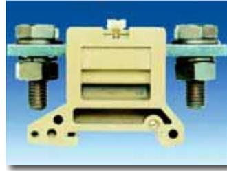
Sie können für Stromschienen und mit Hilfe von Kabelschuhen für alle Leiterarten verwendet werden. Der zusätzliche Platzbedarf und Montageaufwand für die Kabelschuhe muß dabei berücksichtigt werden.
