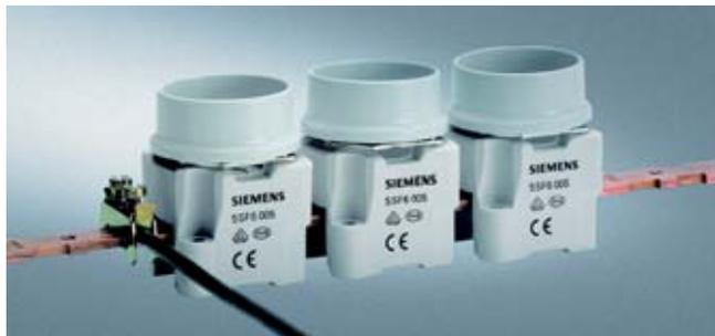
DIAZED-Reitersockel DII für 25 A, 5SF6 005 mit der Klemmenausführung „B“ verschient mit Sammelschiene EZR 5SH3 54. Die zuführenden Leiter sind mit der Reiterklemme 8JH4 122 geklemmt. Die Sammelschiene ist belastbar mit 150 A.
