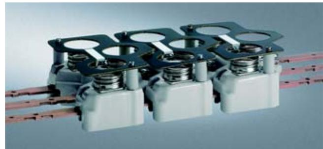
DIAZED-Reitersockel DII 3-phasig für 3 x 25 A, 5SF2 07 mit der Klemmenausführung „B“ verschient mit 3 Sammelschienen EZR 5SH3 54. Die Sammelschienen sind belastbar mit je 150 A.
