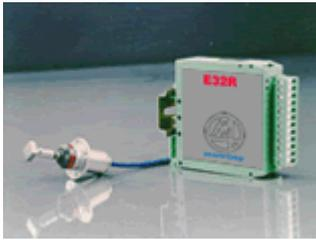
Die Schnittstelleneinheit E32R dient dazu die vom Mida™ Schaltmesskopf erzeugten Signale an die CNC der Werkzeugmaschine anzupassen und schützt das Schaltersystem des Kopfes.
