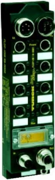
Die FLDP-IM 16-0001 *busstop*<sup>®</sup>-Station ermöglicht die direkte Verbindung an den PROFIBUS-DP. Es können bis zu sechszehn 3-Draht-pnp-Sensoren oder 2-Draht-Sensoren an die Station angeschlossen werden. Die Eingänge werden gesammelt (in Achtergruppen) kurzschlussüberwacht. Die grüne LED zeigt den jeweiligen Signalstatus an. Eine rote LED gibt eine Sammelnkurzschlussmeldung für jeweils 8 Eingänge. Eine grün/rote Bus-LED zeigt den ON-LINE-/OFF-LINE-Status der Station an.
