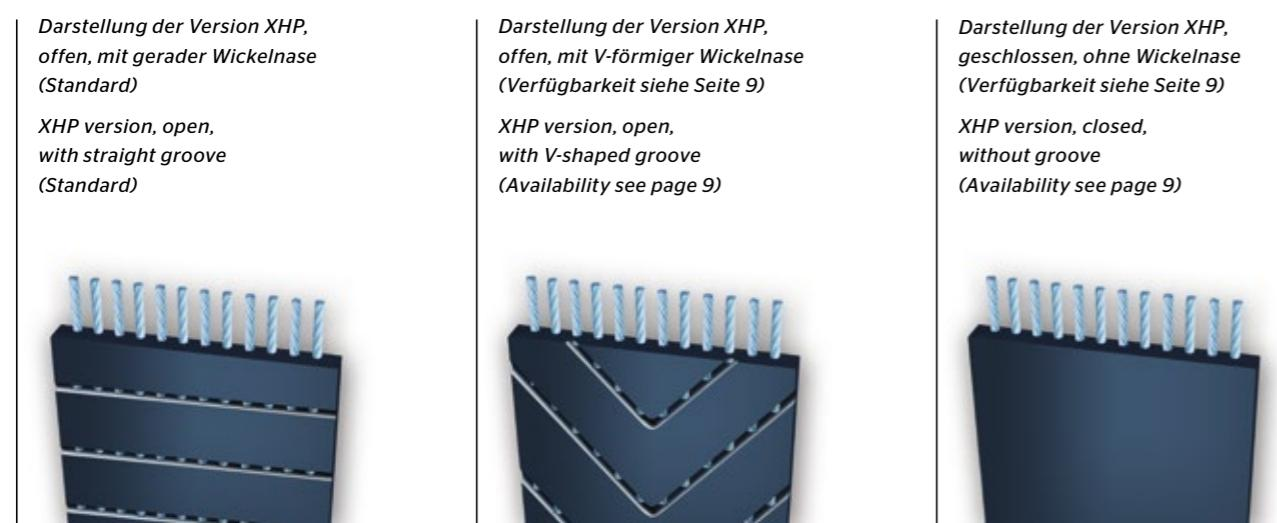
Das Außenmaterial des CONTI® POLYFLAT PU-Flachriemens besteht aus Polyurethan; der Zugträger aus einer Litzenkonstruktion. Die beiden gegenläufigen Schlagrichtungen der Stahlcorde und ihrer Litzen bewirken ein neutrales Laufverhalten.
