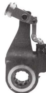
ASA-5® Automatic Slack Adjuster Exterior
